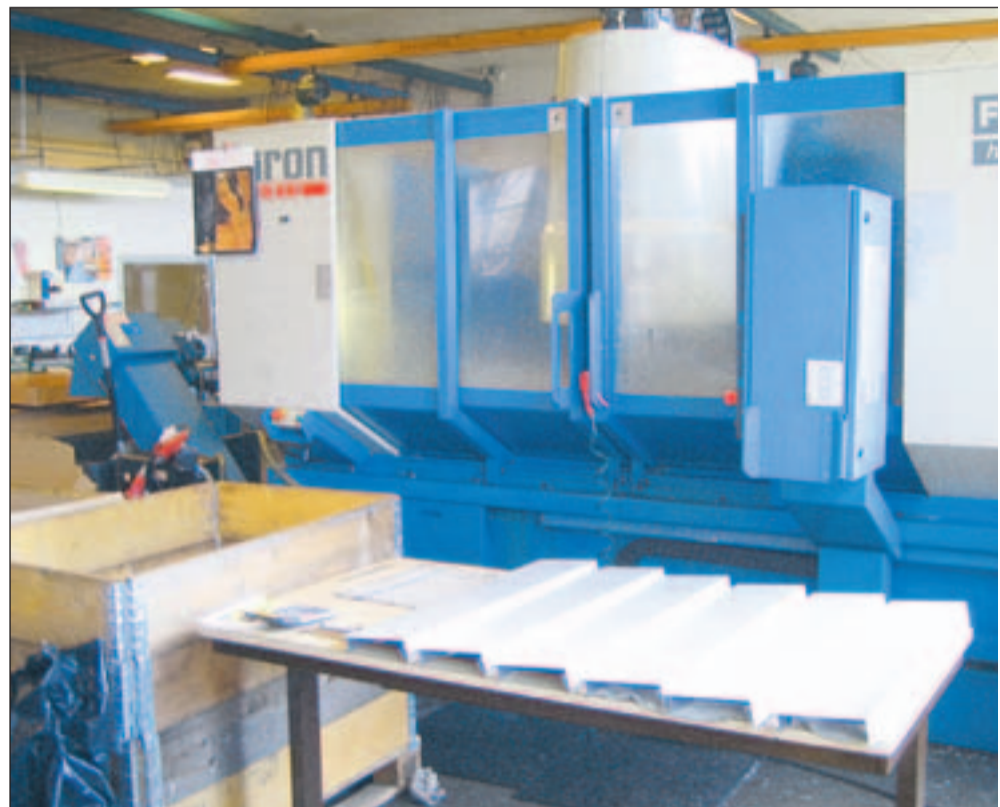
Maskinparken tæller også hele fem Chiron-centre, der alle er forsynet med vakuumanlæg for behandling af pladerne.
